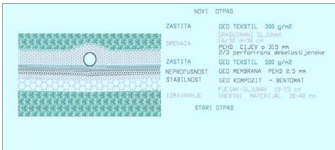
Slika 3: Presjek slojeva temeljnog brtvenog sustava
